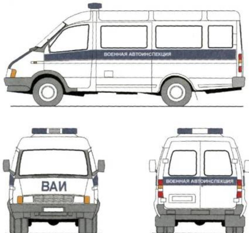
Рисунок А.22 - Цветографические схемы автомобилей Военной автомобильной инспекции
