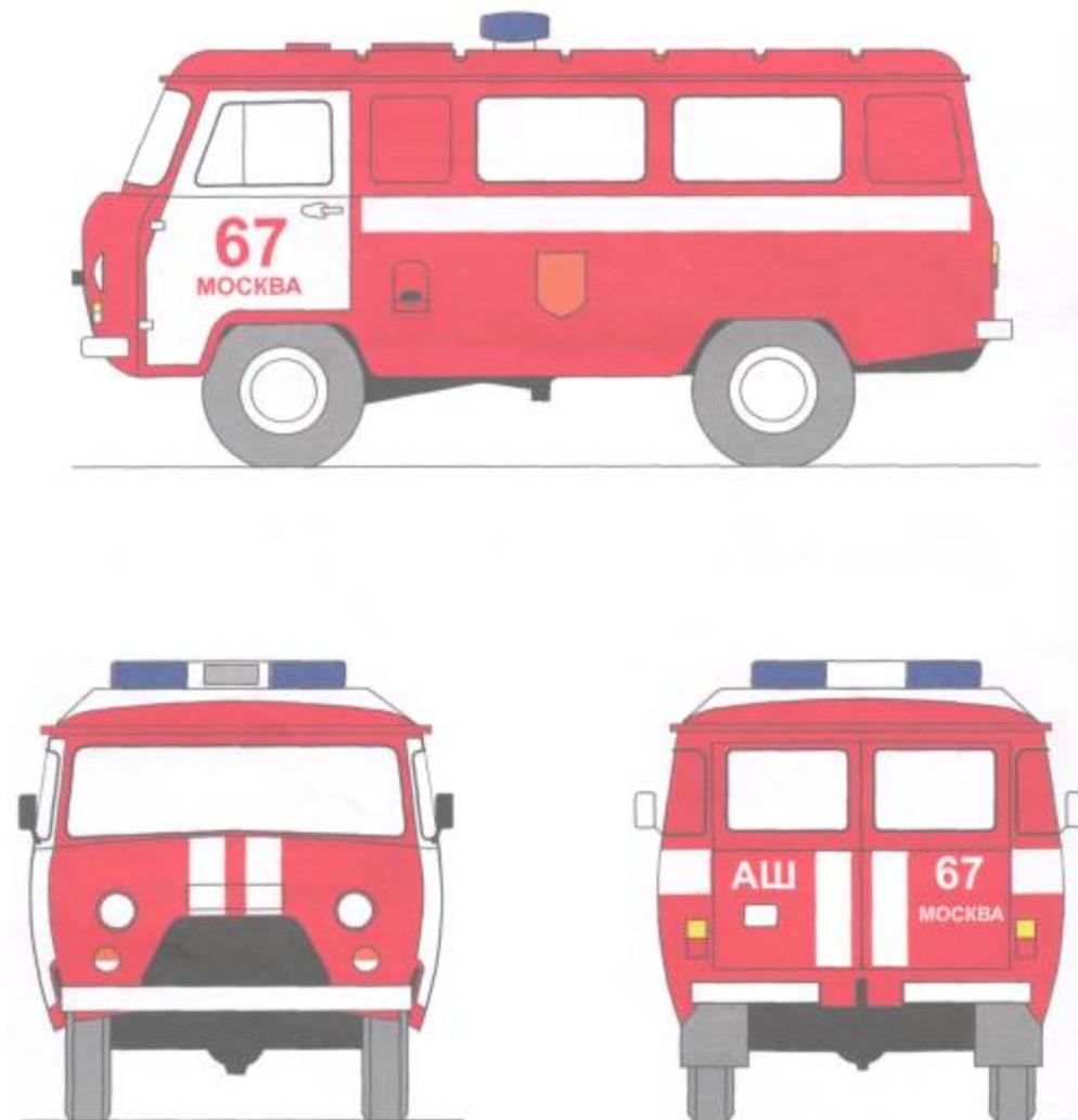
Рисунок А.4 - Цветографические схемы автомобилей пожарной охраны
