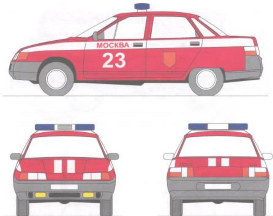
Рисунок А.3 - Цветографические схемы автомобилей пожарной охраны
