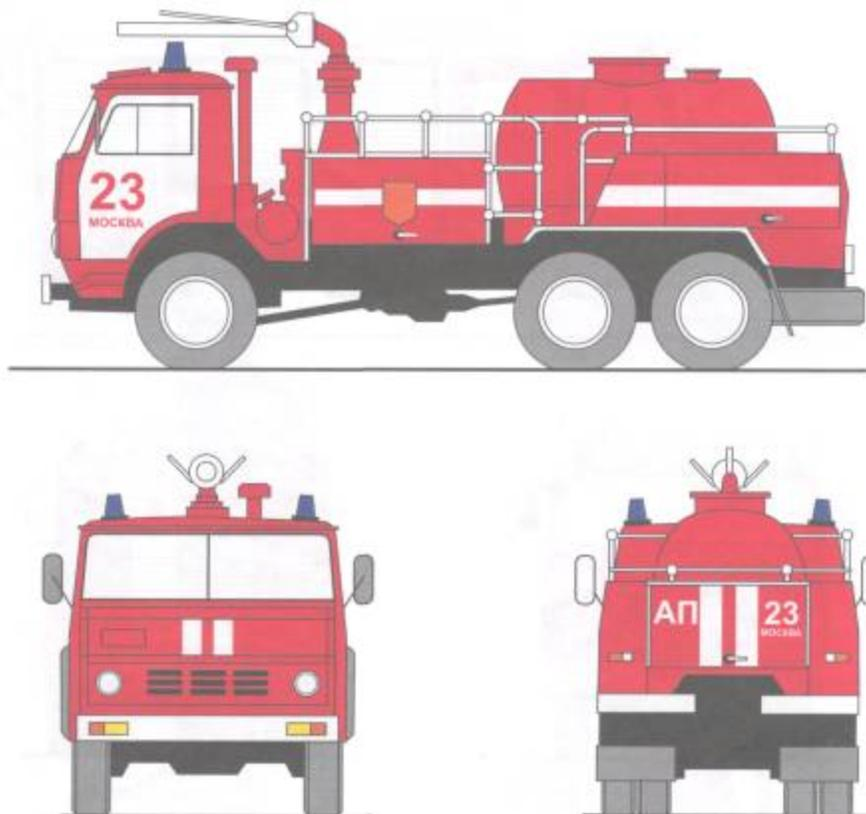
Рисунок А.7 - Цветографические схемы автомобилей пожарной охраны
